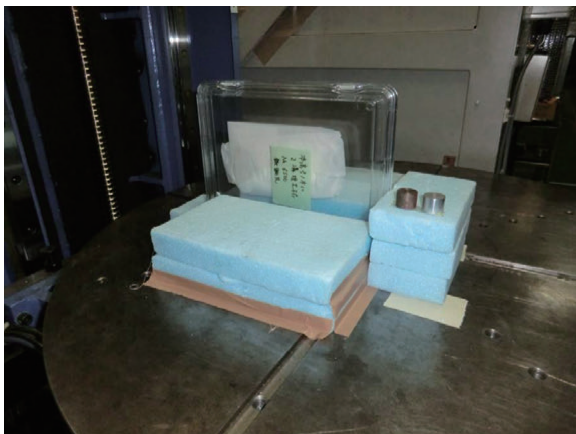
第Ⅷ-9-6 図 X線 CT 分析時の試料の設置状況 2 (長軸方向を水平にした状態で鋤先のみを撮像)
